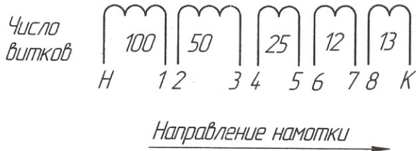
Схема намотки для исполнений 5BK.521090-02, -03
